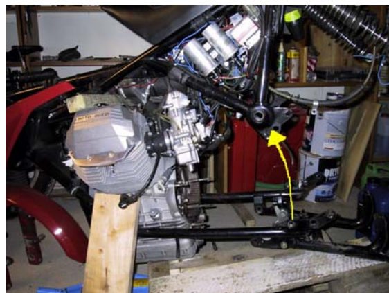
Fig.2 – Vipp ramma opp (litt juks at gearkasse og klutsj allerede er ute på dette bildet!
