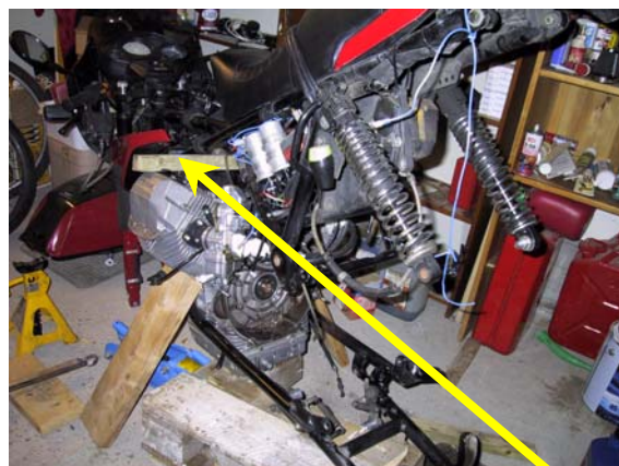
Fig.3 – Støtt/blokkør med en plankebit oppe på motoren
