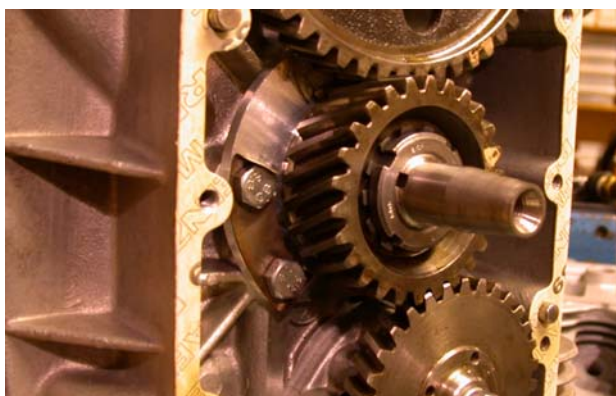
Fig.6 - Spor-mutter på den framre enden av veivakselen (dette er en V7'er, dvs uten registerkjede, men med tannhjul av stål!)
