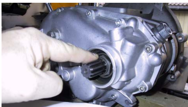
Fig.5 - Mutter på gearkassens kraftutgang
