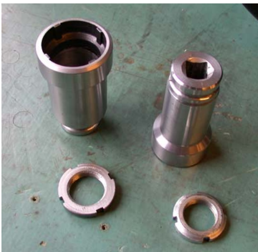
Fig.1- Spor-piper, to dimensjoner, hhv for veivaksel (foran på motoren) og kraftinntak på gearkassen.
