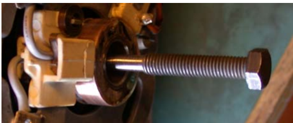
Fig.3-Verktøy for å trekke dynamoen løs fra veivakselen
