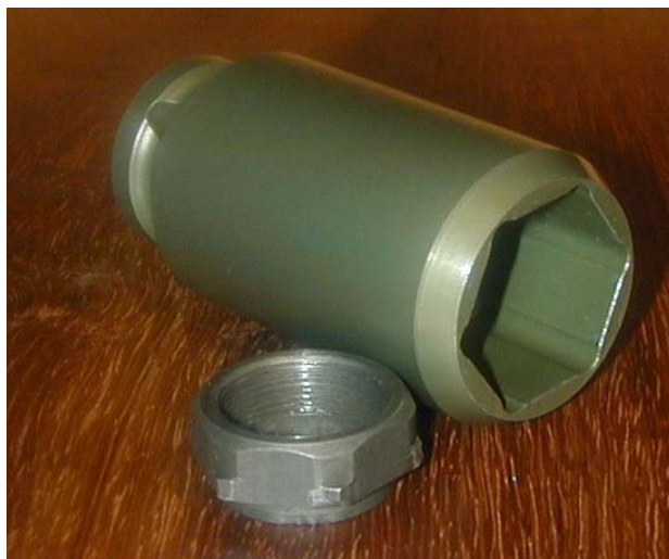
Fig.2-Modifisert sekskantpipe for mutteren på gearkasse kraftutgang.
