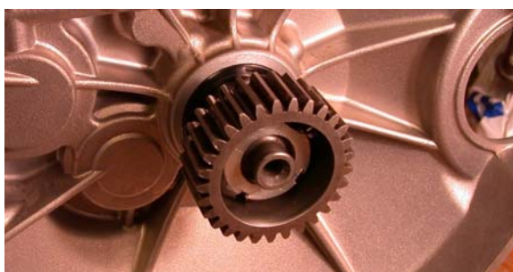
Fig.7 - Spor-mutter på gearkassen mot klutsjen (sees inne i klutsj-boss)
