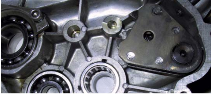
Fig.13 -Lageret på akslingen for kraftuttak (helt til venstre på bildet), sett innefra baklokket i gearkassen
