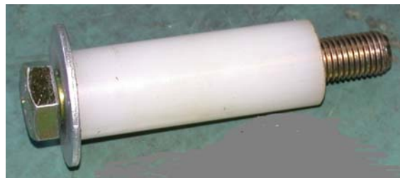
Fig.4-Verktøy for sentrering og forspenning av klutsj under montering.
