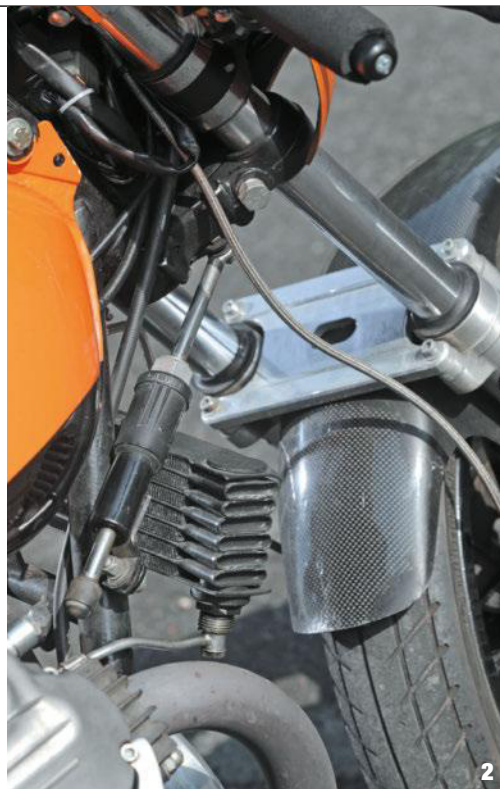
1- Ce carénage de tête de fourche permet de reconnaître la Le Mans entre mille. 2- Radiateur d'huile pour le moteur, pontet de fourche et amortisseur de direction pour la tenue de route. 3- Les carburateurs sont dépourvus de filtre à air : il faut que ça respire.
