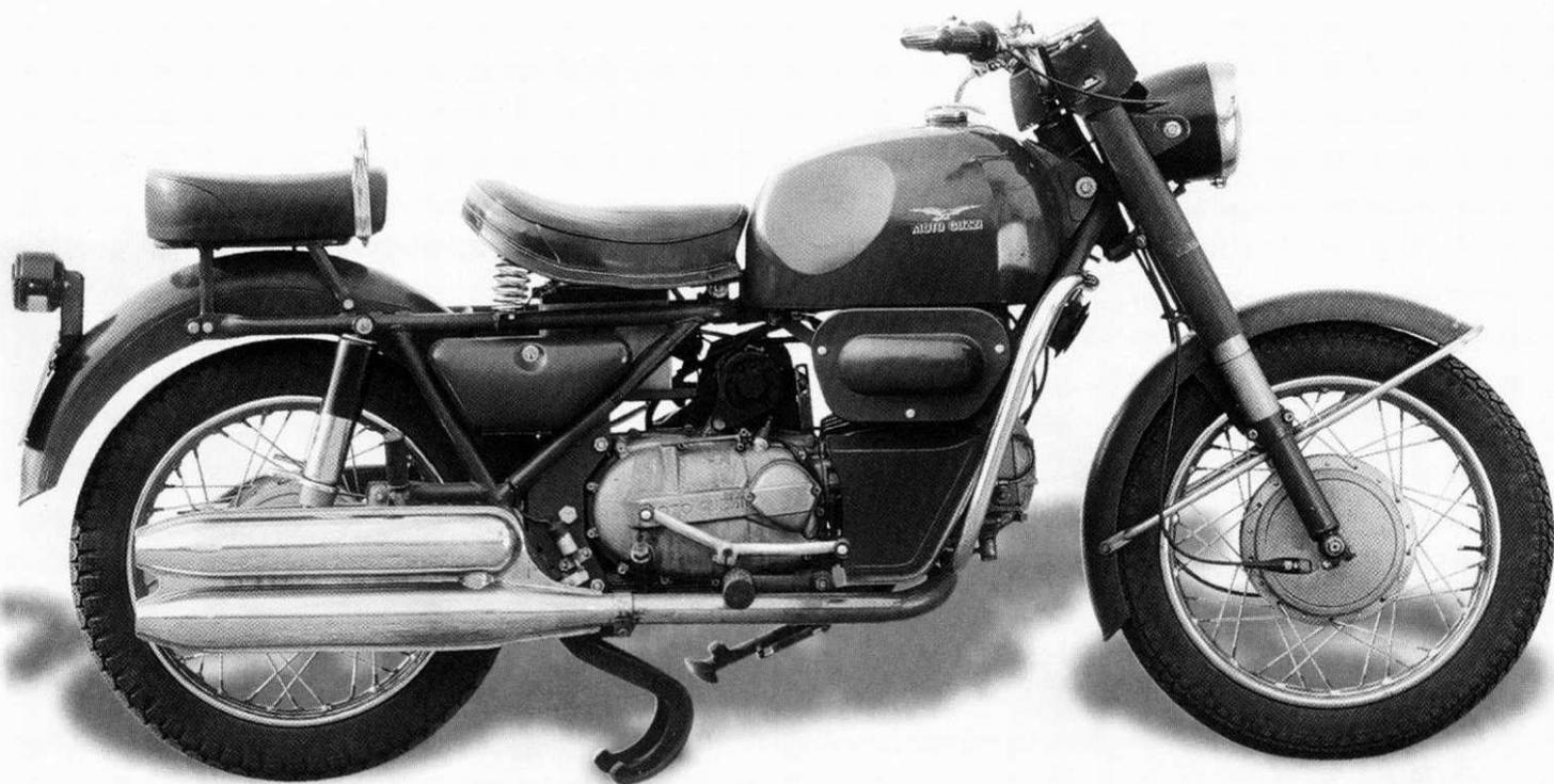
tale, nulla accomuna le due moto. Il motore è dunque un superquadro di 499 cc, eroga 25,4 CV (DIN) a 4.800 giri ed ha la coppia massima di 4 kgm a 3.500 giri. Il cilindro è in lega leggera ad alettatura radiale e canna riportata in ghisa speciale con profondi passaggi per l'aria di raffreddamento sulla testa. Questa, in lega leggera, ha
