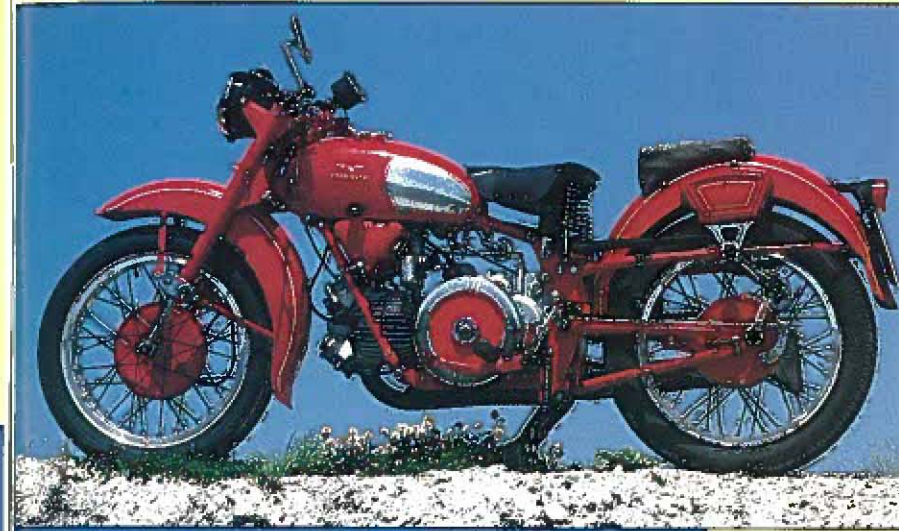
Hochgelegte Lampe und Regler für 60 Watt Lichtmaschine unter dem Sattel, typisch für eine der seltenen Falcone Sport aus den sechziger Jahren
