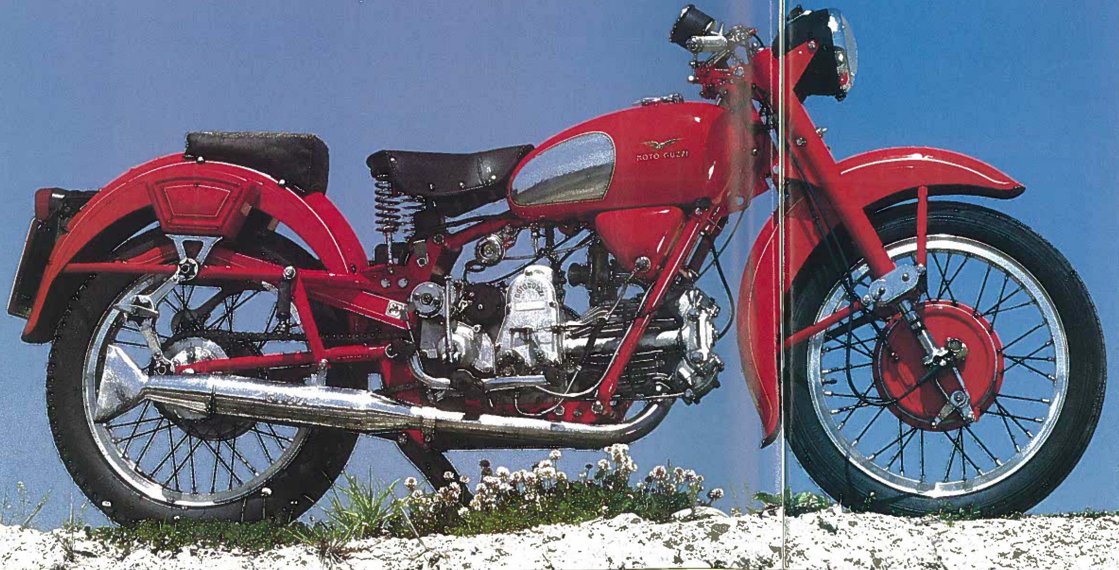
Hochgelegte Lampe und Regler für 60 Watt Lichtmaschine unter dem Sattel, typisch für eine der seltenen Falcone Sport aus den sechziger Jahren
