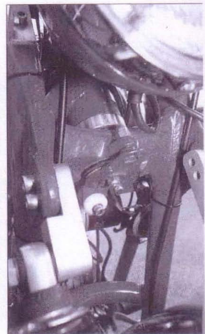
BMW-Schwinge mit Nachlaufverstellung, Distanzring für den zu kurzen Guzzilenkkopf, Reibungsdämpfer übernommen.
