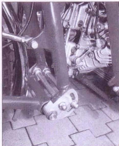
BMW-Schwinge mit Nachlaufverstellung, Distanzring für den zu kurzen Guzzilenkkopf, Reibungsdämpfer übernommen.
