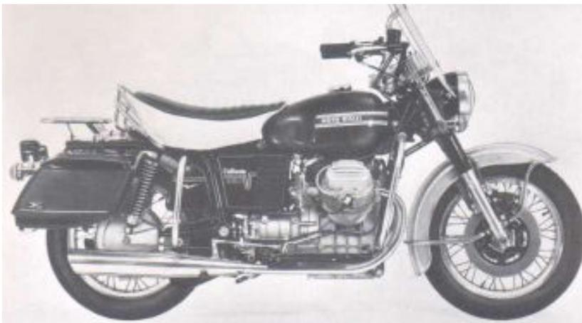
La V7 California fu una moto un po' particolare e conservò alcune delle funzionalità richieste espressamente dai poliziotti USA, come il lampeggio contemporaneo delle quattro frecce e il cavetto con presa da 12V sotto il cruscotto, che serviva ai poliziotti, per esempio, per collegare una lampada durante le ore serali o notturne quando si rendeva necessario consultare della documentazione o stilare verbali.
