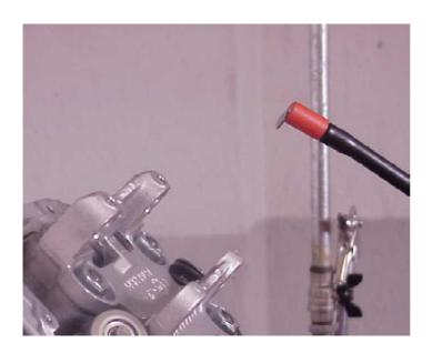
7 PERFORM THE SAME OPERATION ON THE RIGHT CYLINDER AFTER BRINGING THE PISTON TO TDC DURING THE IGNITION STROKE.
