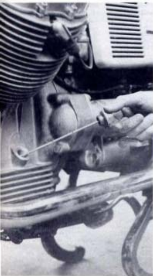
Il tappo per l'olio del motore è munito di asta graduata per il livello.
