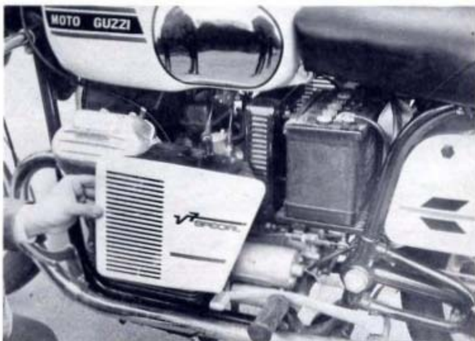
La sistemazione della grossa batteria da 32 Ah; davanti ad essa, la scatola con il filtro aria. Le fiancate in lamiera sono montate su supporti antivibranti.
