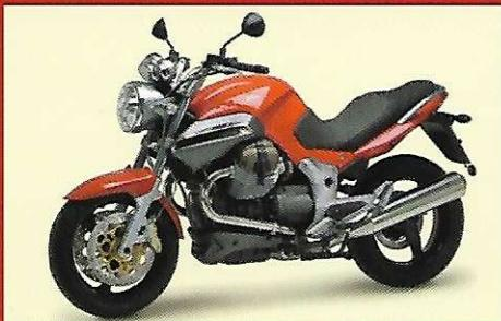
**BREVA V 1100:** Die neue Generation der Moto Guzzi Touren-Motorräder. Italienisches Design und eigenständige Technik. Optimierte: der klassische 90°-V2-Motor mit modernster Einspritz-Technik, Doppelzündung und geregelterm 3-Wege-Katalysator.
