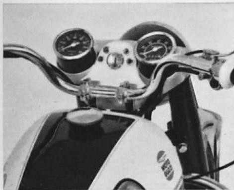
Bild links oben: So sieht die Instrumentierung aus, wenn die Maschine zur Auslieferung kommt. Links Drehzahlmesser, rechts Tachometer — dazwischen Zündschloß und Kontrollleuchten.
