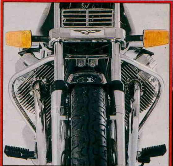
Zwei Zylinder im Guzzi- typischen 90-Grad-Winkel
