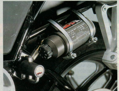
Reservoir: Ausgleichsbehälter mit Einstellrad für die Druckstufendämpfung des Federbeins
