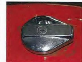
Der Tankverschluss der civile ist abschließbar, bei...
