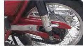
Die Kette bleibt beim Radausbau montiert
