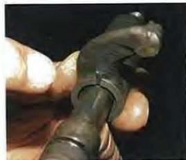
Die Fase der Kipphebelwelle muss zur Markierung passen
