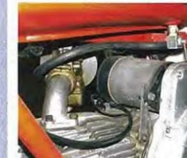
Der Dynastarter wird per Keilriemen angetrieben
