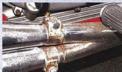
Die beiden Krümmeranschlüsse sind bei der civile besonders rostanfällig
