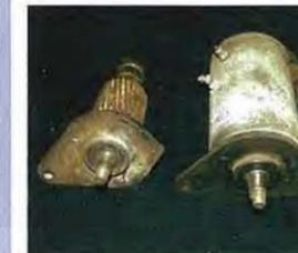
Bruch bei der Halteplatte der Lichtmaschine
