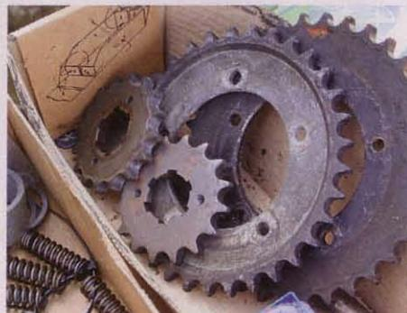
Lieber kürzer: Unterschiedliche hintere Kettenräder erlauben die Anpassung der Übersetzung
