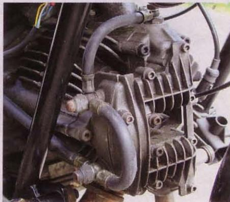
Achillesverse: Der Zylinderkopf ist thermisch hoch belastet und bietet Raum für Optimierungen
