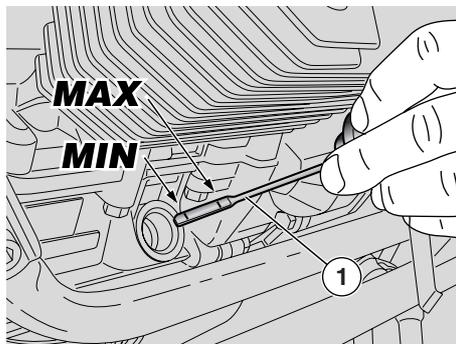
Si l'on effectue le contrôle du niveau de l'huile le moteur froid, l'huile pourrait descendre temporairement au-dessous du niveau "MIN".
