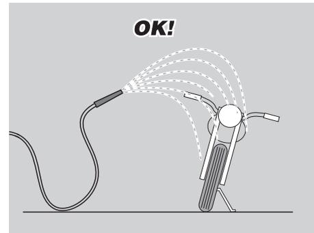
Pour enlever la saleté et la boue qui se sont déposées sur les surfaces peintes, il faut utiliser un jet d'eau à basse pression, arroser soigneusement les parties sales, enlever la boue et la saleté avec une éponge douce pour carrosseries imbibée d'eau et de détergent (2÷ 4% de détergent dans l'eau).
