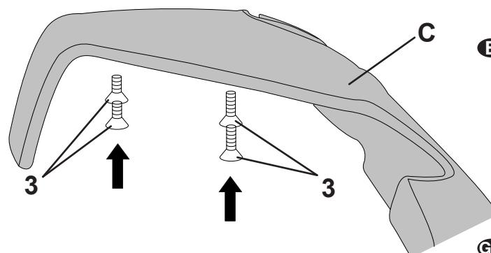
**E** Ensamblar el soporte del navegador que hace parte del juego TomTom 1 y la cubierta de la placa del manillar **C**, interponiendo el soporte en plástico negro **2** suministrado con el juego. Utilizar los cuatro tornillos **3** (los dos de 20mm en la parte anterior y los dos de 15mm en la parte posterior) que se entregan con el juego y apretarlos.
