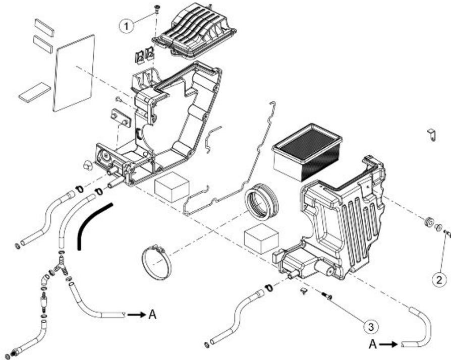
**TIGHTENING TORQUE - CENTRAL PART - FILTER BOX**
