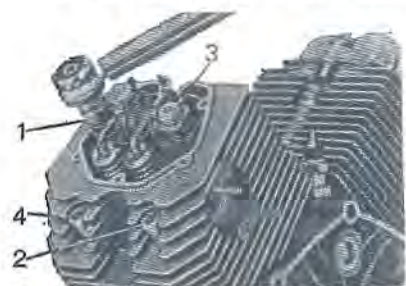
Sl. 66 — Redosled pritezanja navrtki na glavni cilindar pri nameštanju
