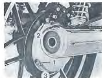
Sl. 62 — Mesta za kontrolu, nalivanje i ispuštanje ulja iz kućišta glavnog prenosa:
