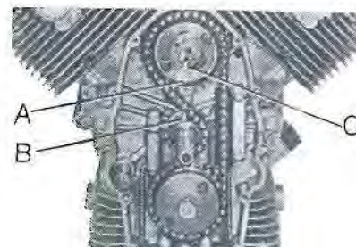
Sl. 83 — Oznaka na bregastom vratilu, pogonskom zupčaniku na bregastom vratilu i na kolensatom vratilu:
