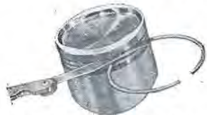
Sl. 94 — Merenje zazora između žleba i klipa i klipnog prstena
