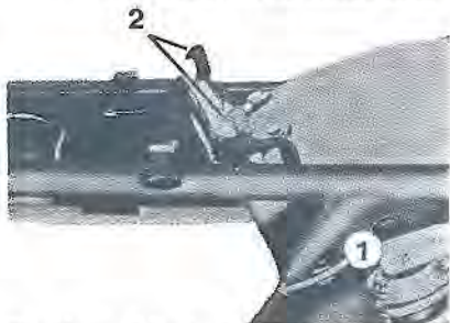
Sl. 51 — Odvajanje sedišta i vađenje akumulatora:
