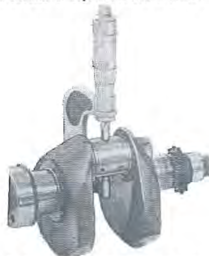
Sl. 96 — Položaj mikrometra pri merenju istrošenosti rukavaca kolenastog vratila
