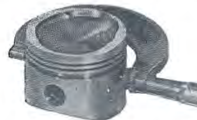
Sl. 92 — Merenje prečnika klipa pomoću mikrometra
