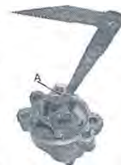
Sl. 107 — Merenje zazora između tela pumpe za ulje i spoljnog rotora: A — merni listić
