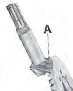
Sl. 144 — Provera zazora između konusnog i tanjirastog zupčanika:
