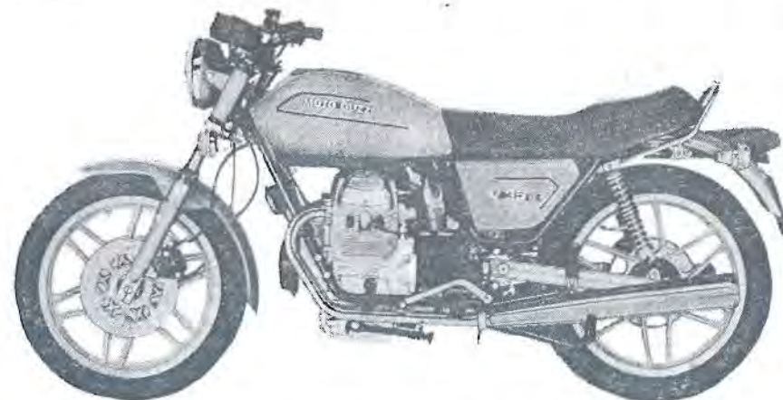
Sl. 1 — Motocikl GUZZI V-35II, 346,22 ccm, izgled sa leve strane
