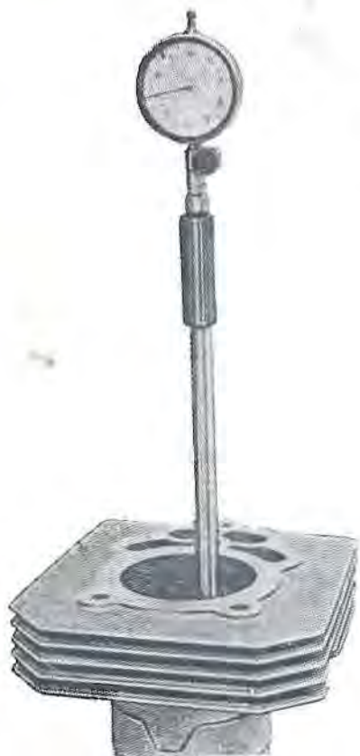
Sl. 90 — Merenje prečnika cilindra komparatorom
