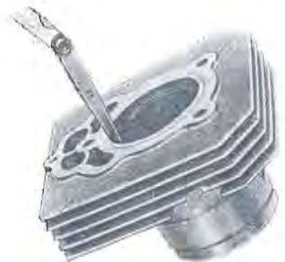
Sl. 95 — Merenje zazora na spoju prstenova klipa pomoću mernih listića
