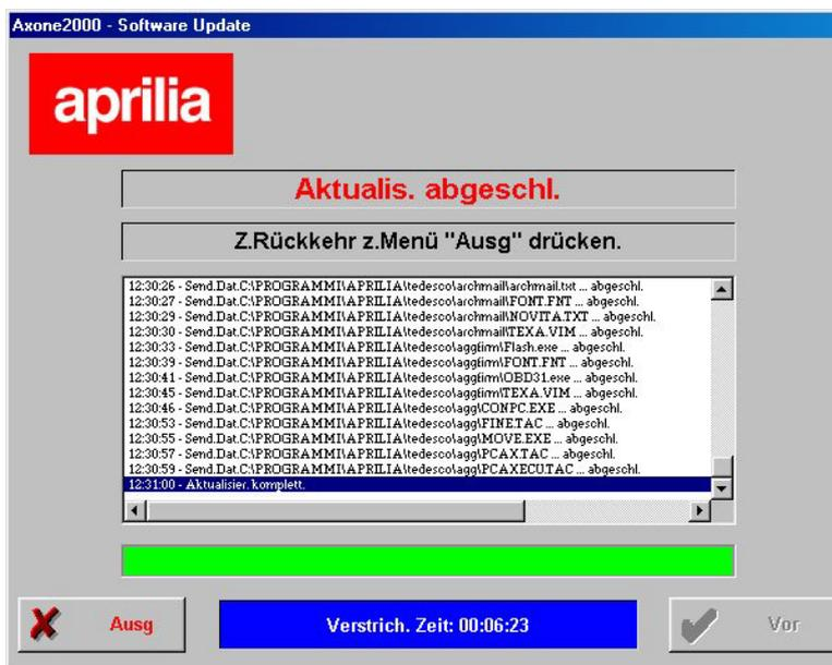
“Beenden” drücken, um das Programm zu verlassen. Auf AXONE2000 APRILIA erscheint der Hinweis “Aktualisierung abgeschlossen. Instrument aus- und wieder anschalten.”
