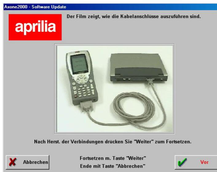
Es erscheint ein Video, der zeigt, wie das Kabel zwischen PC und AXONE 2000 angeschlossen werden muss. Wenn dieser Arbeitsschritt am eigenen PC ausgeführt wurde, klickt man auf "Weiter", um das Programm fortzusetzen.
