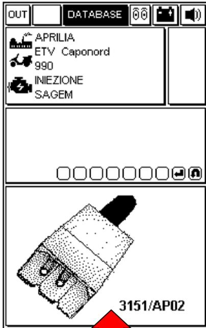
TIPO DE CONECTOR QUE SE DEBE UTILIZAR PARA CONECTAR AXONE2000 CON LA CENTRAL
